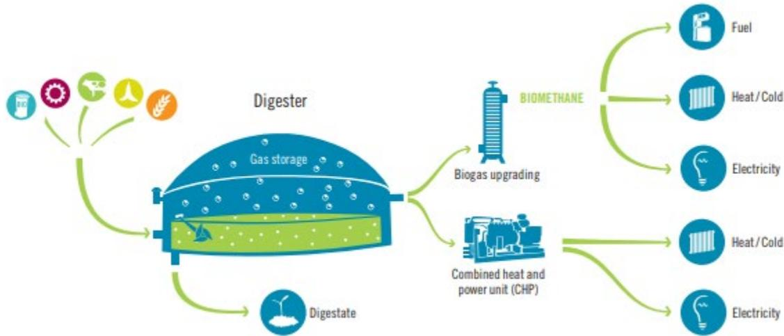
Figure 3 Flowchart of a Digester (Fachverband Biogas e.V., 2017)
