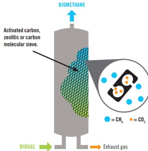
Figure 4 Pressure Swing Adsorption Process (Fachverband Biogas e.V., 2017)
