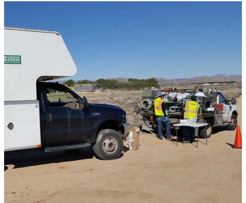
Los equipos del USGS llevan a cabo el muestreo de las aguas subterráneas en los pozos locales para la actualización del estudio de antecedentes.
