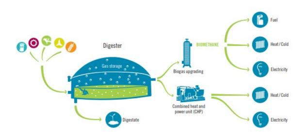
Figure 3 Flowchart of a Digester (Fachverband Biogas e.V., 2017)
