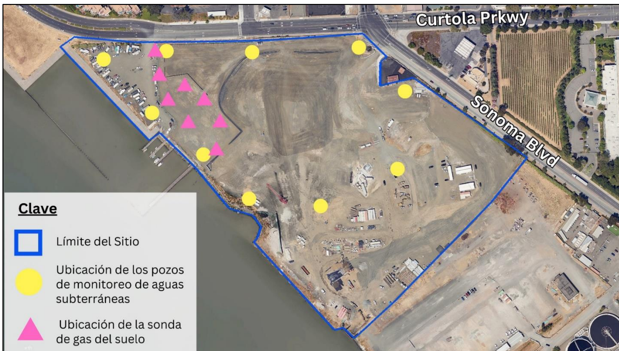
Figura 2 – Mapa que muestra el lugar de las sondas de gas del suelo y los pozos de monitoreo de las aguas subterráneas que se instalarán.
